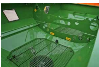
Ein kontinuierlicher Materialfluss zur Auslauföffnung hin war bei trockenem Dünger gewährleistet.
