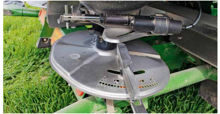
Nur drei Streuscheibenpaare decken den gesamten Arbeitsbereich von zehn bis 36 Meter ab. Die Arbeitsbreite wird unkompliziert und schnell über die Streuschaufelposition verstellt. Das Einstellen der Streuschaufeln erfolgt komplett werkzeuglos über das Verstellsystem QuickSet.
