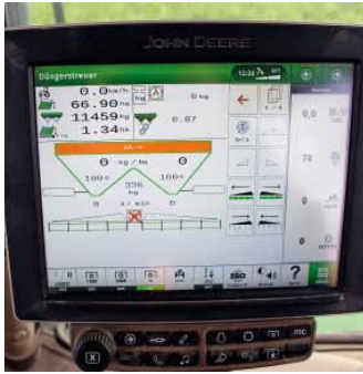
Auf der Hauptmaske der Anzeige sind alle wichtigen Grundfunktionen wie Menge pro Hektar, Füllstand und weiteres sauber dargestellt.
