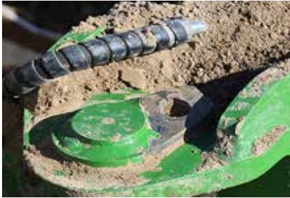
Die Schwachstelle im Drehgelenk des Aufsattelrades wurde laut Amazone beseitigt.
