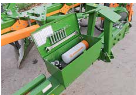
In die große und stabile Box passen Werkzeug – ein 24/30er Maulschlüssel wird mitgeliefert – und vieles mehr (links). Nicht alle Schmiernippel sind gut erreichbar.
