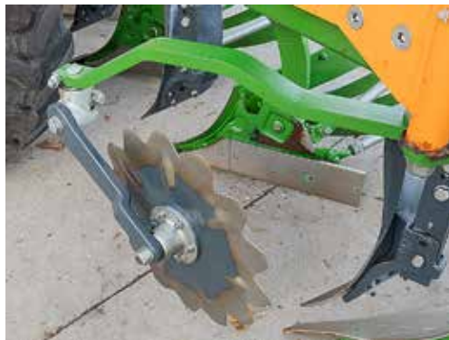
Neben der Tiefe kann beim Dungeinleger auch der Über-/Unterschnitt durch Umsetzen der Platte verstellt werden (links). Das weit vorgesetzte Scheibensech verstopfte nie.
