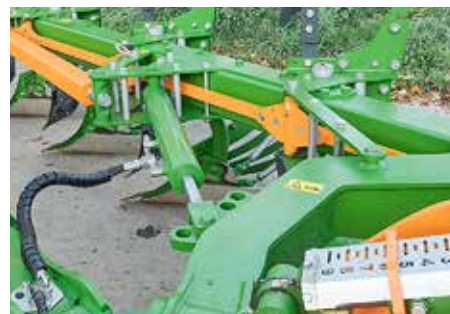
Drei hydraulische Verstellmöglichkeiten mit prima Skalen für guten Komfort: Vorderfurchenbreite (oben), Arbeitstiefe (rechts oben) und Schnittbreite (rechts unten).
