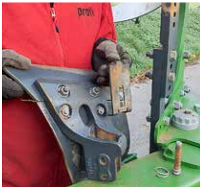
Neben der Tiefe kann beim Dungeinleger auch der Über-/Unterschnitt durch Umsetzen der Platte verstellt werden (links). Das weit vorgesetzte Scheibensech verstopfte nie.
