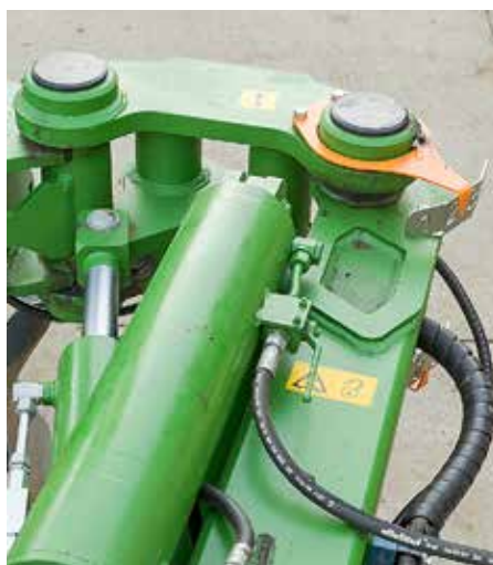
Drei hydraulische Verstellmöglichkeiten mit prima Skalen für guten Komfort: Vorderfurchenbreite (oben), Arbeitstiefe (rechts oben) und Schnittbreite (rechts unten).
