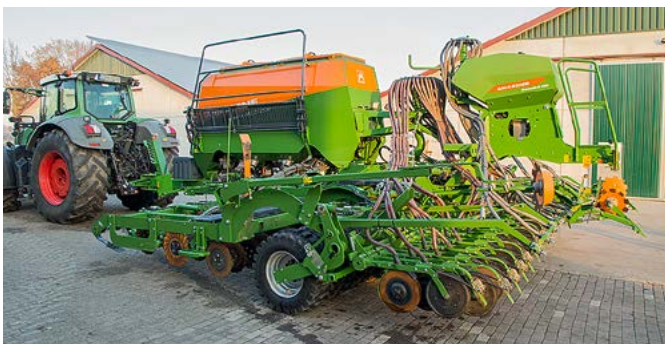
Die Sämaschine der Partner ist mit drei Saattanks und drei Abgabeorten für das Saatgut versehen.
